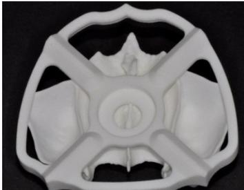
Modello stereolitografico con lavorazione Flyone® (opzione B/C): nel caso specifico, si tratta di una replica mascellare: vista palatale, vestibolare e paranasale
